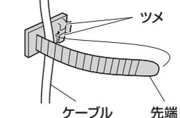
②ケーブルタイの先端を引き、ケーブルを固定します。
