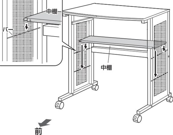
**5** サイドフレームの下方に補強パイプ(丸)を取付け、底板を引っ掛けます。
