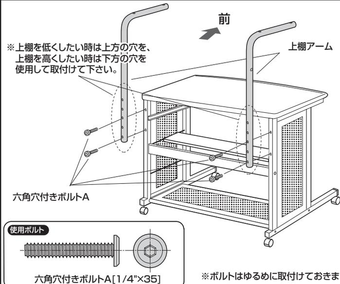
**7** 上棚アームに補強パイプ(丸)を取付けます。
