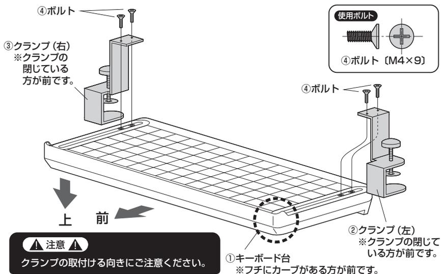
**2 天板にキーボード台のクランプを差し込み、ノブボルトで固定して完成です。**
