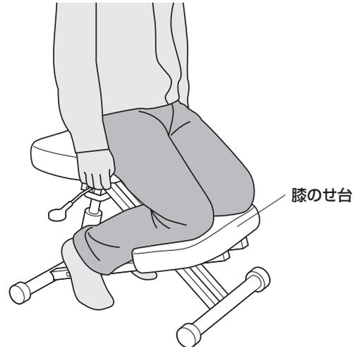
3. レバーを引き上げて高さを調節します。
