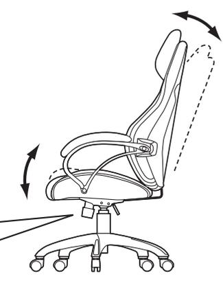
下から見て、ツマミを時計回りに回すとロックが固くなり、反時計回りに回すと緩くなります。
