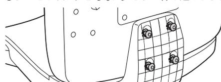
③最後に下図の1,2,3,4の順にきつく締め付けます。
