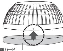
上面にある印(左図)と前ガードにある印の位置を合わせ、軽く押し込みます。
