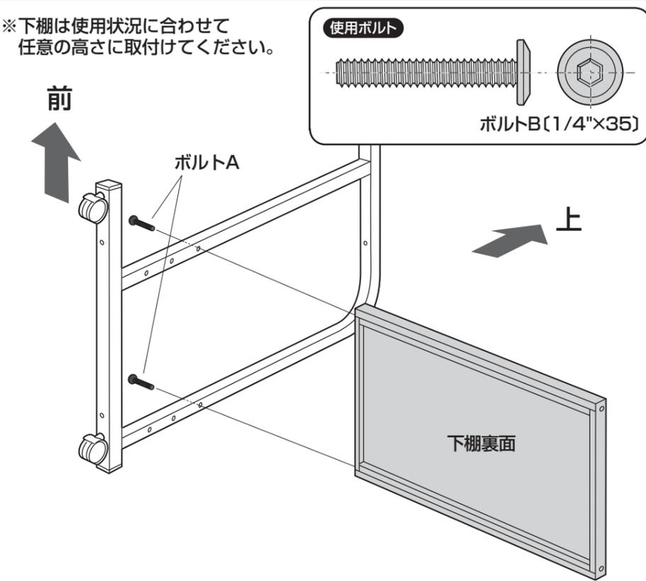
3 同様にして反対側のサイドフレームを取付けます。
