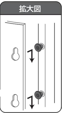
※バックパネルを引っ掛けてボルトを締め込みます。
