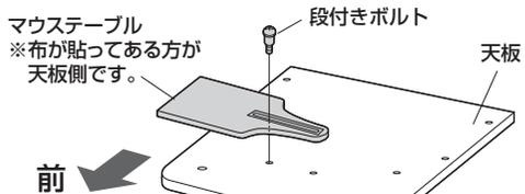
②マウステーブル取付けブラケットで固定します。
