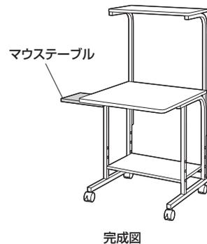
①マウステーブルを段付きボルトで取付けます。
