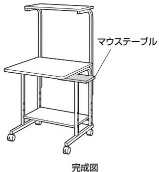
①マウステーブルを段付きボルトで取付けます。
