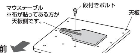
②マウステーブル取付けブラケットで固定します。
