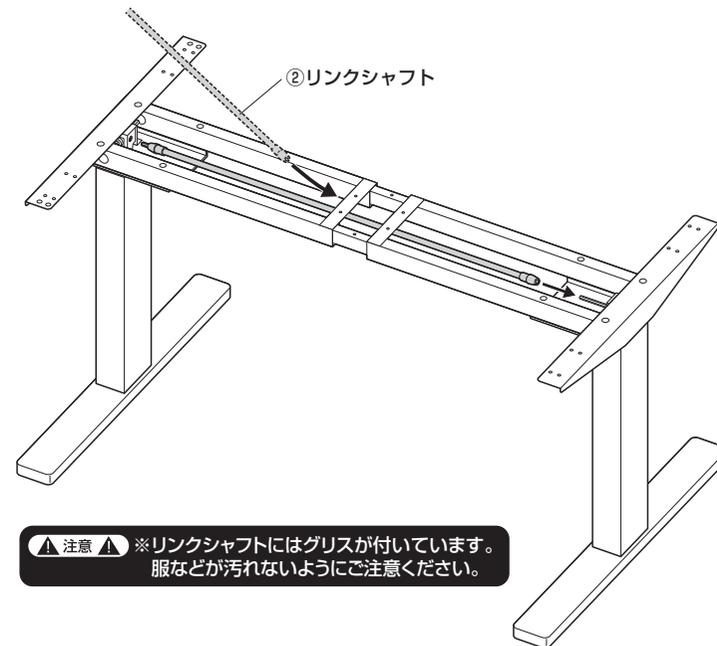
昇降フレームAの六角棒にリンクシャフトの六角穴を差込みます。
