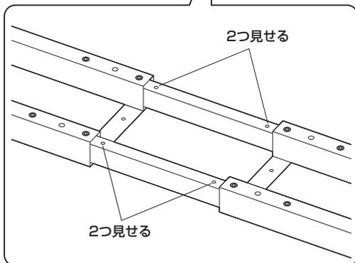
③下図のボルトを締め付けて固定します。
